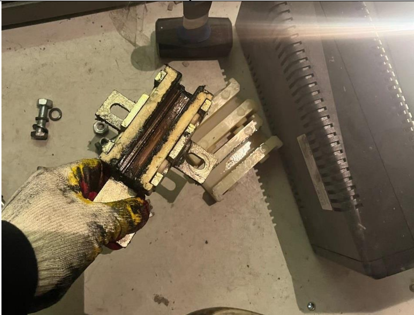
Замена верхних вкладышей.
