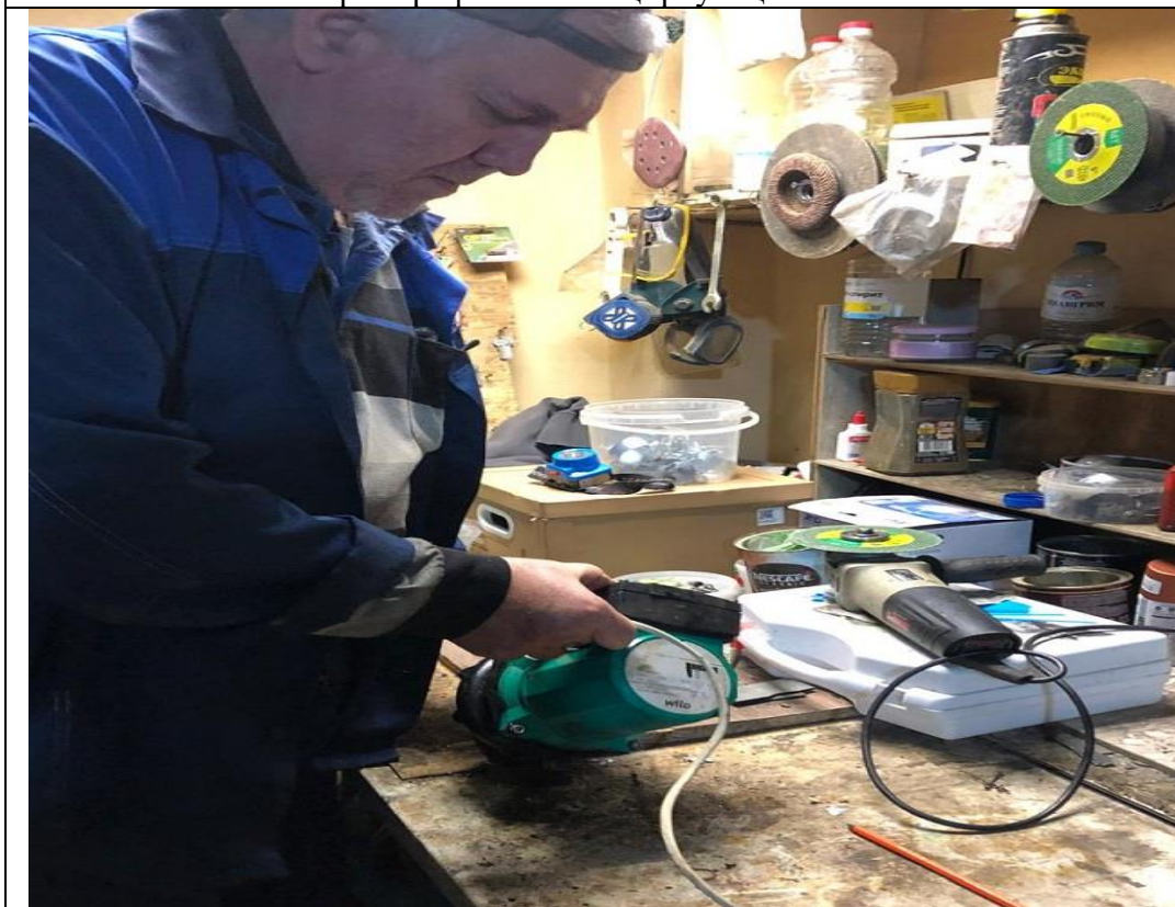
Осмотр и профилактика циркуляционного насоса
